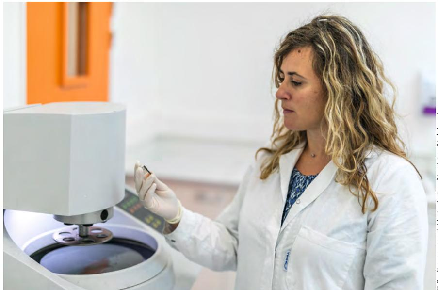
**Plateforme de métallographie** : polissage d'échantillons au LEM3 de Metz (CNRS, Université de Lorraine et Arts & Métiers)
