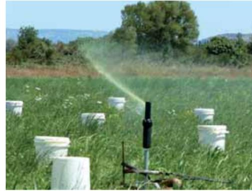
Évaluation de la dérive d'aérosols sous aspersion, avec des eaux additionnées de colorant, pour simuler une eau usée.
