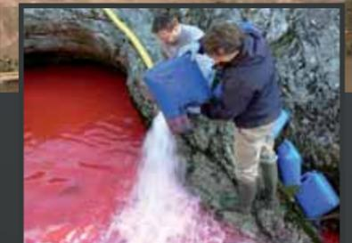
L'injection d'un traceur sert à suivre le cheminement souterrain de l'eau pour caractériser les systèmes karstiques.
